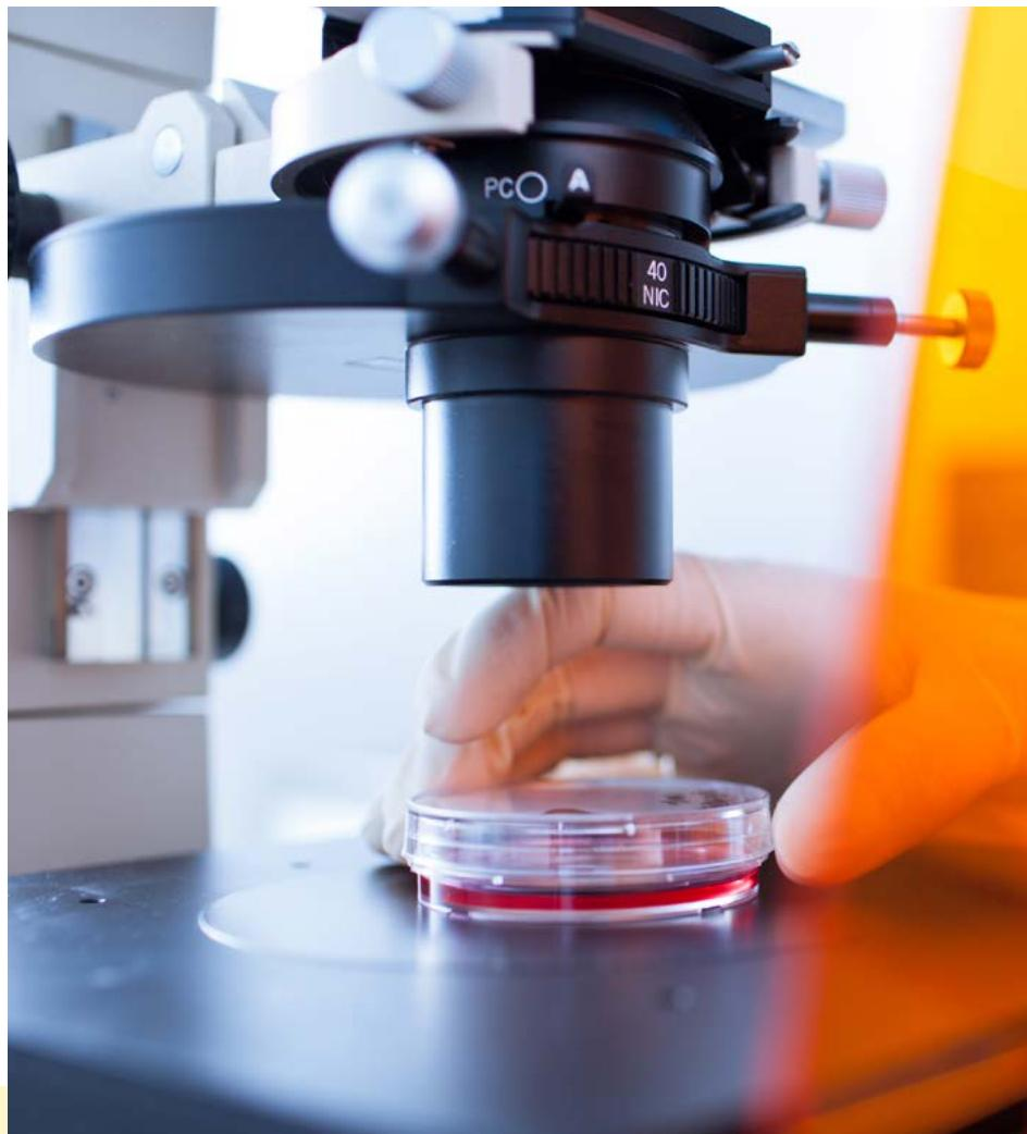
Lámina de color naranja, que absorbe la longitud de onda más allá de los rayos UV, super anti-UV, que se utiliza para proteger las superficies fotosensibles (inactínicas). Use LABO, o en un taller de soldadura, por su color, en multicapa que protege los ojos de los arcos de soldadura.
